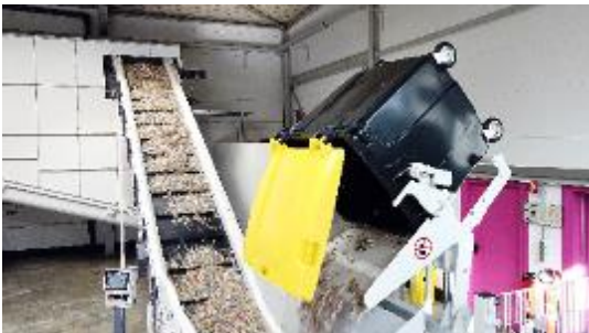
Bild 2: Das vorzerkleinerte und von Eisen befreite Material gelangt vom Container auf die Fördertechnik.
