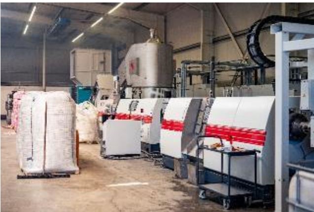
Bild 9: In den nachgelagerten Prozessen wird das zerkleinerte Material von metallischen Störstoffen bereinigt und anschließend dem Extruder zugeführt.
