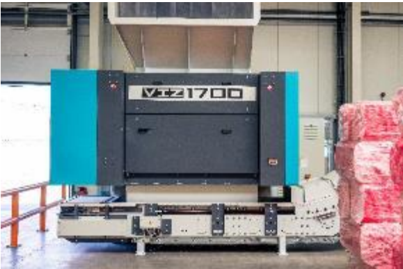
Bild 4: Der VIZ 1700 hat eine Durchsatzleistung von etwa 2.000 Kilogramm in der Stunde. Der Schredder ist hoch verfügbar und überzeugt durch niedrige Betriebskosten.
